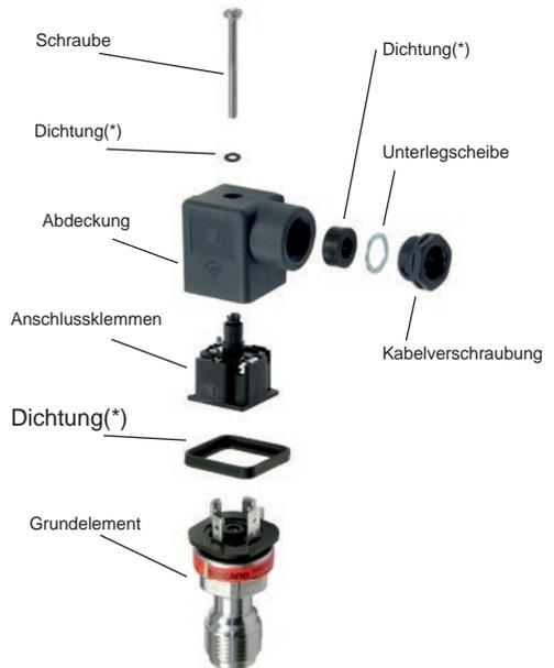
(\* ) Diese Dichtungen sind unbedingt notwendig zum Erreichen der Schutzart des Produkts (IP65)!
