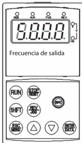
Fig.4-3c. indicación con variador funcionando
